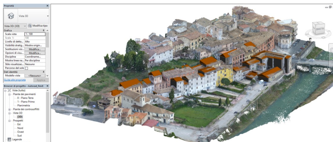
Figura 5-47 Integrazione del modello parametrico 3D alla nuvola di punti del rilievo fotogrammetrico digitale
