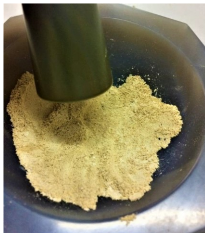
Figura 5-59 Campione di pietra da analizzare ridotto in polvere
