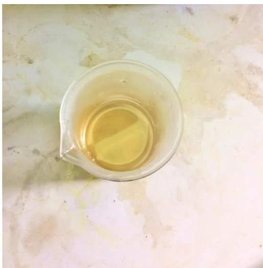
Figura 5-57 Prodotto della reazione chimica avvenuta tra acido cloridrico e carbonato di calcio
