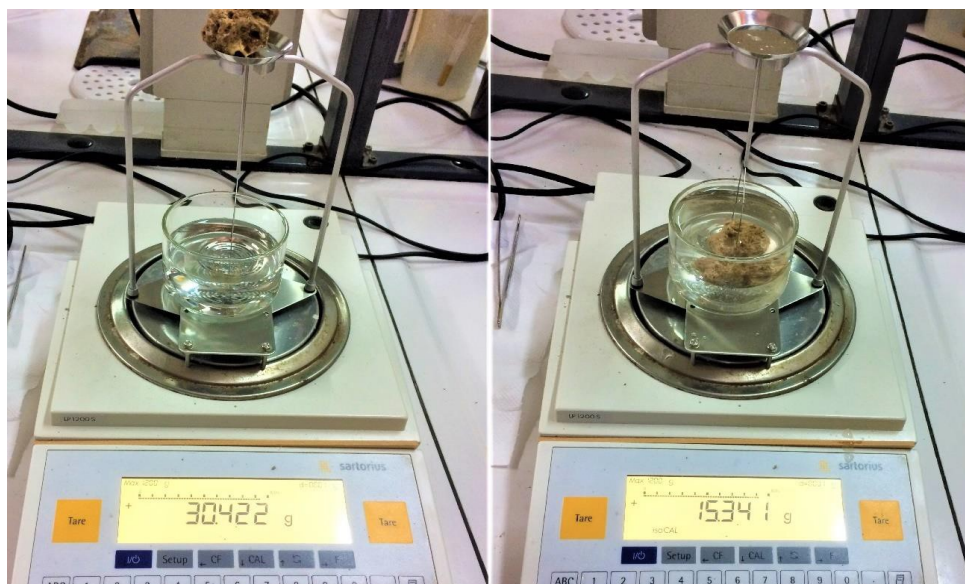
Figura 5-56 Bilancia idrostatica a) misurazione peso impregnato b) misurazione peso immerse
