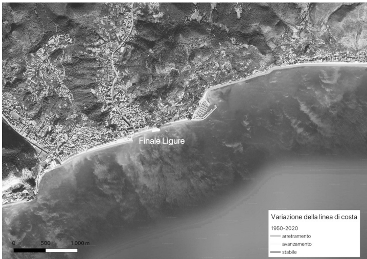
Fig. 1 – Variazione della linea di costa a est e a ovest del porto di Finale Ligure (SV), tra 1950 e 2020 (fonte: elaborazione su dati ISPRA e Google Satellite).
