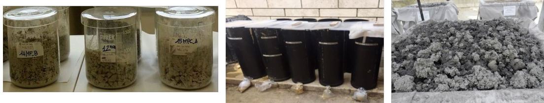
Figura 2. Microcosmi e mesocosmi sperimentali in laboratorio e in campo allestiti per valutare la degradazione dei componenti principali dei prodotti schiumogeni utilizzati negli scavi con TBM, effettuati con terreni provenienti direttamente dal sito di scavo
