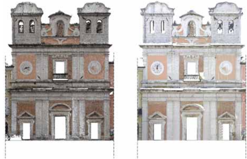
Fig. 10 - Confronto tra i processi SFM e Laser Scanning [10].
