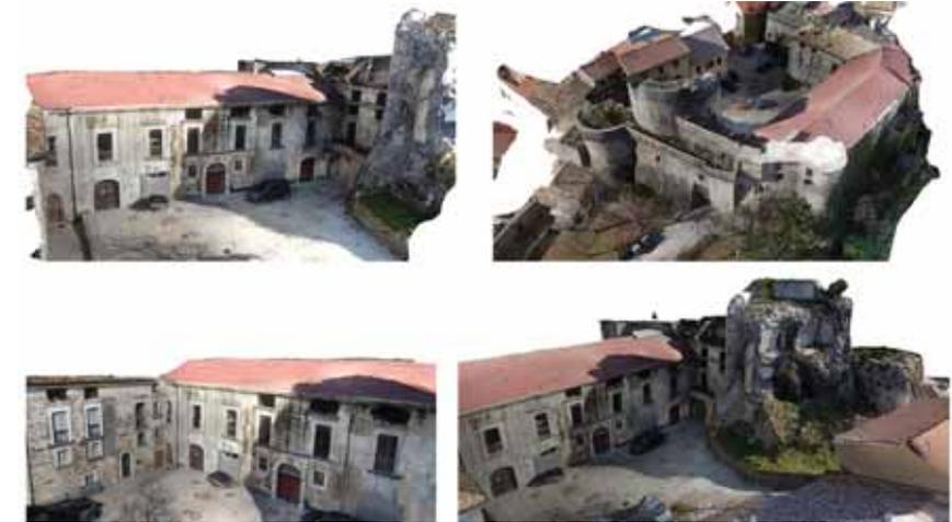
Fig. 9 - Immagini da fotogrammetria con drone del castello di Picinisco (modello 3D di Ennio Pirolò sito Sketchfab).
